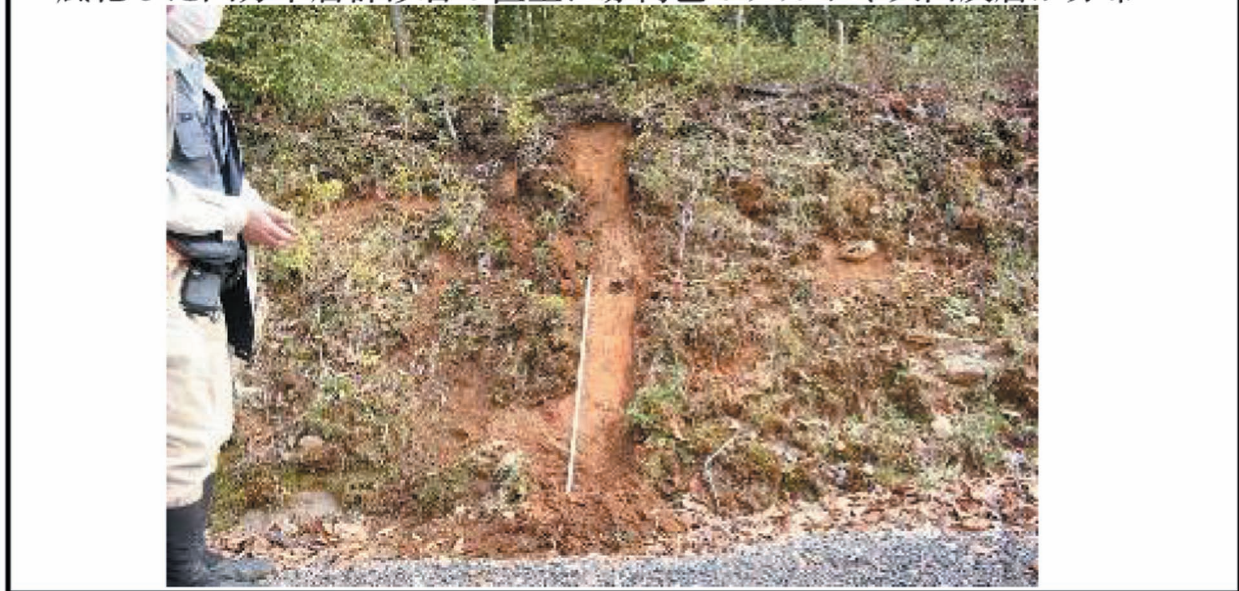
7号風車付近の稜線部で見つかった表層地質の完全露頭 風化した四万十層群砂岩の直上に赤褐色のアカホヤ火山灰層が分布
